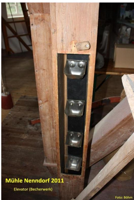
Das Becherwerk wird durch einen Elektromotor angetrieben. Ein Antrieb über Wind ist grundsätzlich möglich. Das Becherwerk transportiert das Korn über die **Kornpfeifen (Kornpiep)** nicht nur zu den Mahlgängen sondern durch entsprechende Verteilerstellung in der Kappe bei Bedarf auch zum Getreidesilo, den Reinigungsmaschinen oder dem Schrotmischer.
