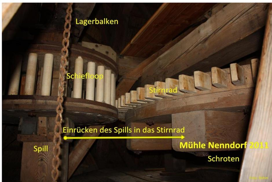
Nach dem alle Sturmsicherungen entfernt sind, der Läuferstein sich frei bewegen kann und das Achslager geschmiert ist, kann die Mühle von der Galerie aus in Gang gesetzt werden.
